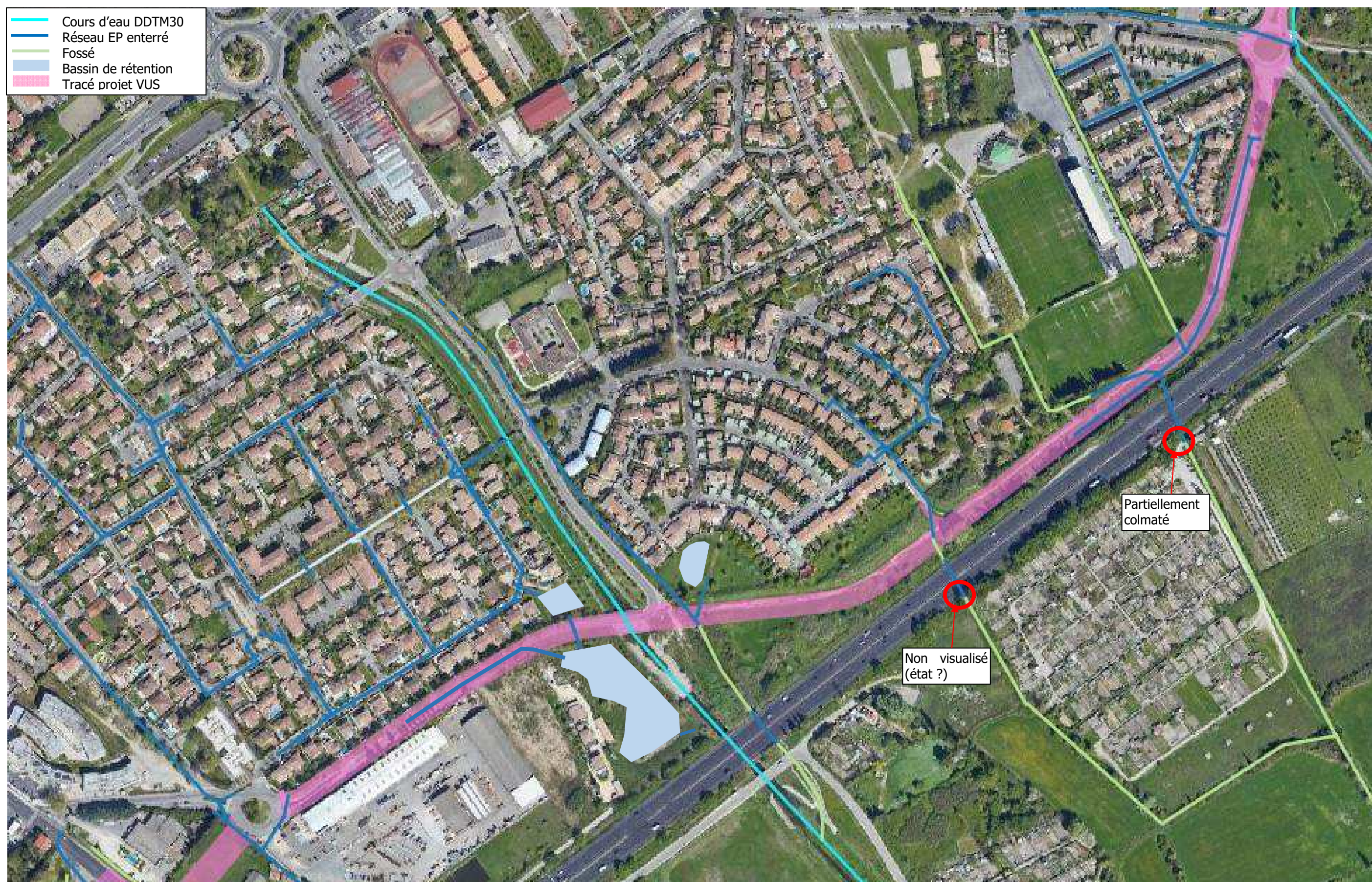
Figure 10 : Réseau EP existant
