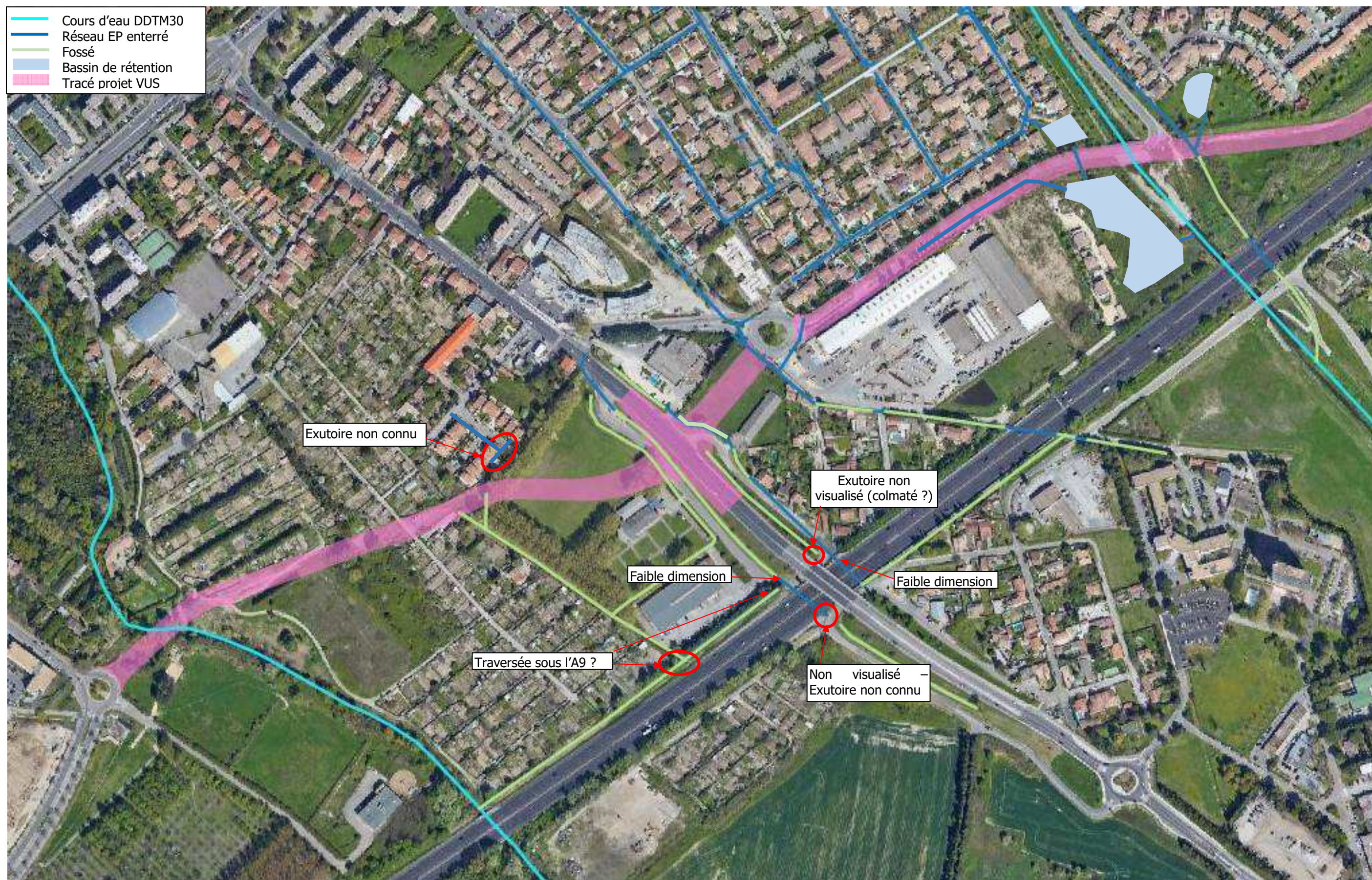
Figure 9 : Réseau EP existant
