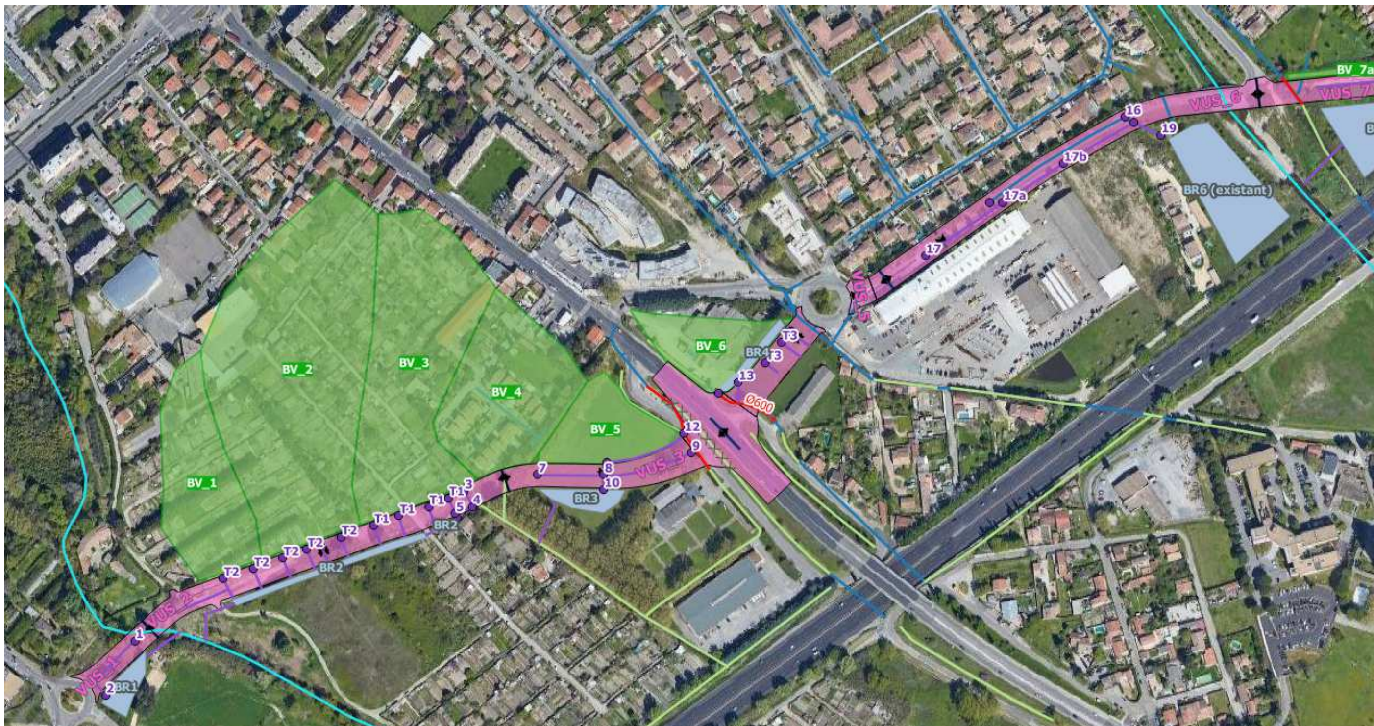
Figure 6 : Synoptique de l'assainissement pluvial projeté (1/3)
